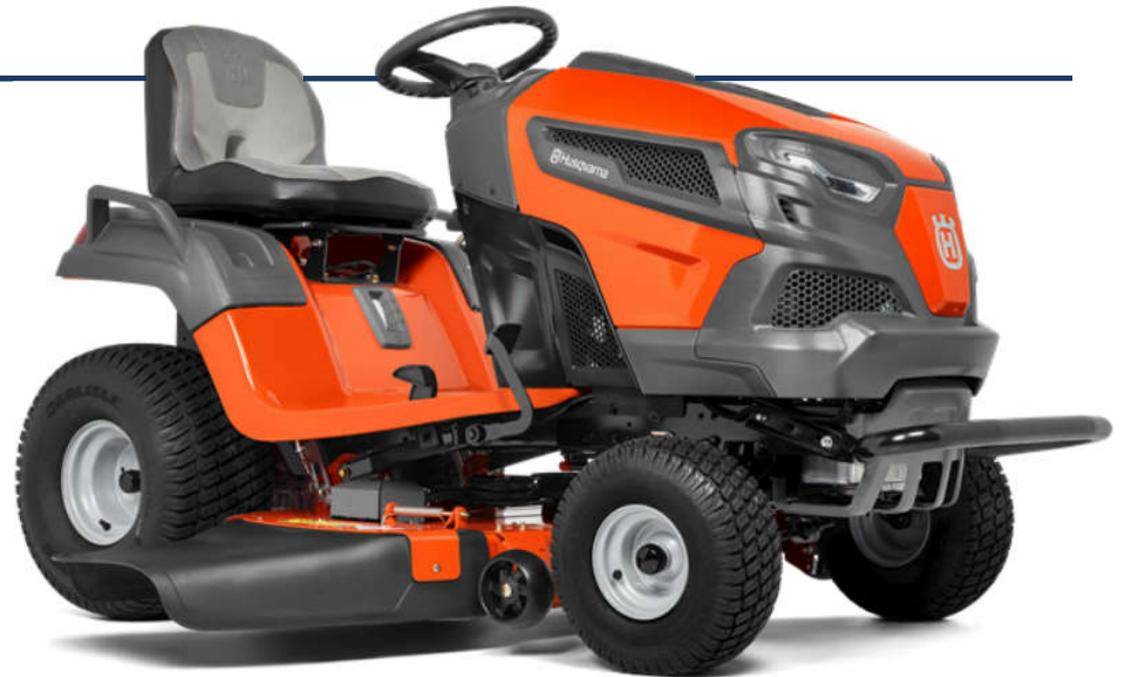
**Embrayage des lames électrique** : facilite l'embrayage de la (ou des) lame(s), il suffit de tirer une manette sur le tableau de bord.
